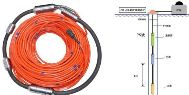
图 2-3-1 自激振式探头外观
