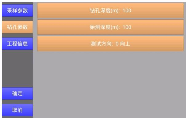
图 4-8-5 土层横波(孔中激振式)钻孔参数界面
